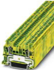
Schutzleiter-Reihenklemme, Anschlussart: Zugfederanschluss, Querschnitt: 0,08 mm 2 - 4 mm 2 , AWG: 28 - 12, Breite: 5,2 mm, Farbe: grün-gelb, Montageart: NS 35/7,5, NS 35/15
