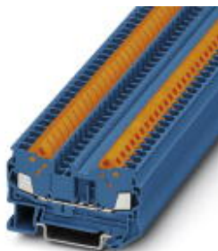
Durchgangsklemme, Anschlussart: Schnellanschluss, Querschnitt: 0,5 mm 2 - 2,5 mm 2 , AWG: 20 - 14, Breite: 6,2 mm, Farbe: blau, Montageart: NS 35/7,5, NS 35/15
