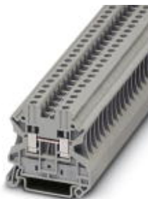
Durchgangsklemme, Anschlussart: Schraubanschluss, Querschnitt: 0,14 mm 2 - 6 mm 2 , AWG: 26 - 10, Breite: 6,2 mm, Farbe: grau, Montageart: NS 35/7,5, NS 35/15
