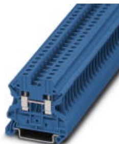
Durchgangsklemme, Anschlussart: Schraubanschluss, Querschnitt: 0,14 mm 2 - 6 mm 2 , AWG: 26 - 10, Breite: 6,2 mm, Farbe: blau, Montageart: NS 35/7,5, NS 35/15
