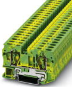
Schutzleiter-Reihenklemme, Anschlussart: Zugfederanschluss, Querschnitt: 0,2 mm 2 - 10 mm 2 , AWG: 24 - 8, Breite: 8,2 mm, Farbe: grün-gelb, Montageart: NS 35/7,5, NS 35/15
