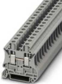
Durchgangsklemme, Anschlussart: Schraubanschluss, Querschnitt: 0,2 mm 2 - 10 mm 2 , AWG: 24 - 8, Breite: 8,2 mm, Farbe: grau, Montageart: NS 35/7,5, NS 35/15
