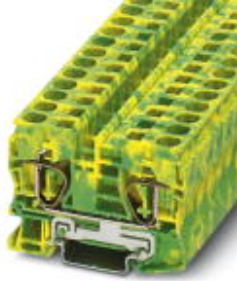
Schutzleiter-Reihenklemme, Anschlussart: Zugfederanschluss, Querschnitt: 0,2 mm 2 - 16 mm 2 , AWG: 24 - 6, Breite: 10,2 mm, Farbe: grün-gelb, Montageart: NS 35/7,5, NS 35/15
