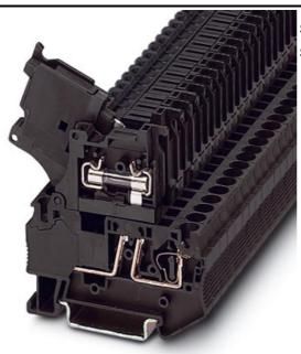
Sicherungsklemme zur Montage auf NS 35, für G-Sicherungseinsätze 5 x 20, 5 x 25 und 5 x 30 mm
