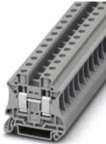
Durchgangsklemme, Anschlussart: Schraubanschluss, Querschnitt: 0,5 mm 2 - 16 mm 2 , AWG: 20 - 6, Breite: 10,2 mm, Höhe: 46,9 mm, Farbe: grau, Montageart: NS 35/7,5, NS 35/15
