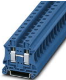
Durchgangsklemme, Anschlussart: Schraubanschluss, Querschnitt: 0,5 mm 2 - 16 mm 2 , AWG: 20 - 6, Breite: 10,2 mm, Höhe: 46,9 mm, Farbe: blau, Montageart: NS 35/7,5, NS 35/15
