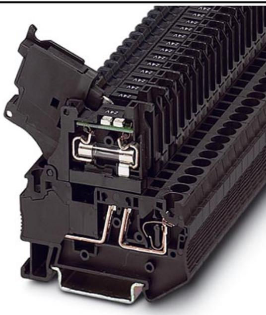
Sicherungsklemme mit Leuchtanzeige zur Montage auf NS 35, für G-Sicherungseinsätze 5 x 20, 5 x 25 und 5 x 30 mm
