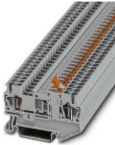
Messer-Trennklemme, Anschlussart: Zugfederanschluss, Querschnitt: 0,08 mm 2 - 4 mm 2 , AWG: 28 - 12, Nennstrom: 20 A, Nennspannung: 400 V, Länge: 60,5 mm, Breite: 5,2 mm, Farbe: grau, Montage: NS 35/7,5, NS 35/15
