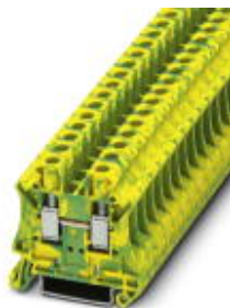
Schutzleiter-Reihenklemme, Anschlussart: Schraubanschluss, Querschnitt: 0,2 mm 2 - 10 mm 2 , AWG: 24 - 8, Breite: 8,2 mm, Farbe: grün-gelb, Montageart: NS 35/7,5, NS 35/15
