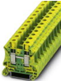
Schutzleiter-Reihenklemme, Anschlussart: Schraubanschluss, Querschnitt: 0,5 mm 2 - 16 mm 2 , AWG: 20 - 6, Breite: 10,2 mm, Höhe: 46,9 mm, Farbe: grün-gelb, Montageart: NS 35/7,5, NS 35/15
