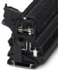
Sicherungsreihenklemme, Anschlussart: Schraubanschluss, Querschnitt: 0,14 mm<sup>2</sup>- 6 mm<sup>2</sup>, AWG: 26 - 10, Nennstrom: 6,3 A, Nennspannung: 500 V, Breite: 6,2 mm, Sicherungstyp: G / 5 x 20, Art der Sicherung: Glas, Montageart: NS 35/7,5, NS 35/15, Farbe: schwarz
