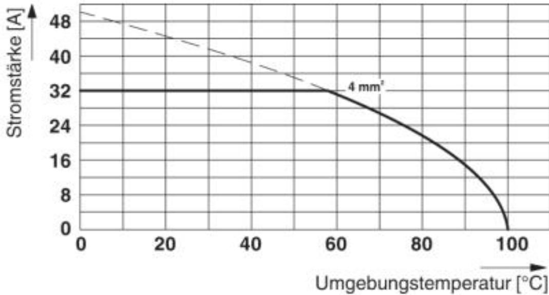
Derating-Diagramm für 5 Pole; Reduktionsfaktor=1
