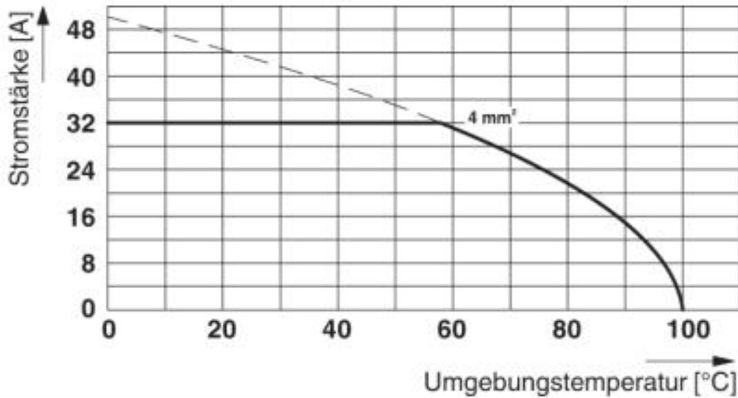
Typ: MKDS 5/2-6,35 und MKDS 5/3-6,35 Prüfung in Anlehnung an DIN EN 60512-5-2:2003-01 Reduktionsfaktor = 1 Polzahl: 5
