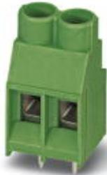
Leiterplattenklemme, Nennstrom: 32 A, Nennspannung: 630 V, Rastermaß: 6,35 mm, Polzahl: 2, Anschlussart: Schraubanschluss, Montage: Löten, Anschlussrichtung Leiter/Platine: 0 °, Farbe: grün, Der Artikel ist zu unterschiedlichen Polzahlen anreihbar!
