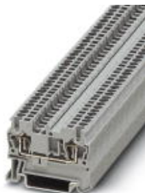
Durchgangsklemme, Anschlussart: Zugfederanschluss, Querschnitt: 0,08 mm 2 - 1,5 mm 2 , AWG: 28 - 16, Breite: 4,2 mm, Farbe: grau, Montageart: NS 35/7,5, NS 35/15
