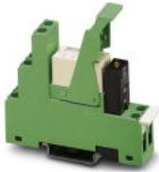
Vormontierte Relaismodule PR1-RSC... mit Schraubanschluss, bestehend aus: Relaissockel, Mehrlagenkontaktrelais, steckbarem Anzeige-/ Entstörm modul und Haltebügel. Eingangsspannung: 230 V AC, 1 Wechsler, 12 A
