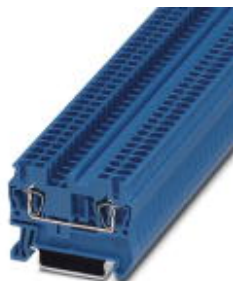
Durchgangsklemme, Anschlussart: Zugfederanschluss, Querschnitt: 0,08 mm 2 - 4 mm 2 , AWG: 28 - 12, Breite: 5,2 mm, Farbe: blau, Montageart: NS 35/7,5, NS 35/15
