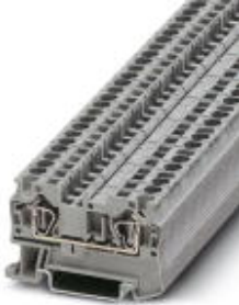
Durchgangsklemme, Anschlussart: Zugfederanschluss, Querschnitt: 0,08 mm 2 - 6 mm 2 , AWG: 28 - 10, Breite: 6,2 mm, Farbe: grau, Montageart: NS 35/7,5, NS 35/15
