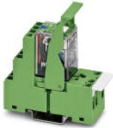
Vormontierte Relaismodule mit Schraubanschluss, bestehend aus: Relaissockel, Industrirelais mit integrierter LED und rastbarer Handbetätigungstaste, Varistormodul und Haltebügel. Eingangsspannung: 230 V AC, 4 Wechsler mit vergoldeten Kontakten, 5 A
