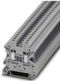
Durchgangsklemme, Anschlussart: Schraubanschluss, Querschnitt: 0,14 mm 2 - 4 mm 2 , AWG: 26 - 12, Breite: 5,2 mm, Farbe: grau, Montageart: NS 35/7,5, NS 35/15
