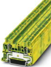
Schutzleiter-Reihenklemme, Anschlussart: Zugfederanschluss, Querschnitt: 0,08 mm 2 - 1,5 mm 2 , AWG: 28 - 16, Breite: 4,2 mm, Farbe: grün-gelb, Montageart: NS 35/7,5, NS 35/15
