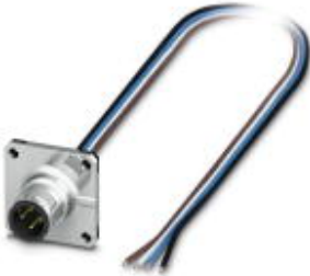
Sensor-/Aktor-Einbaustecker, 4-polig, M12, A-kodiert, Vorderwand-/Vierkantflanschmontage, mit 0,5 m TPE-Litze, 4 x 0,34 mm 2
