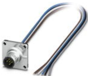
Sensor-/Aktor-Einbaustecker, 5-polig, M12, A-kodiert, Vorderwand-/Vierkantflanschmontage, mit 0,5 m TPE-Litze, 5 x 0,34 mm 2
