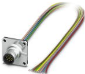
Sensor-/Aktor-Einbaustecker, 8-polig, M12, A-kodiert, Vorderwand-/Vierkantflanschmontage, mit 0,5 m TPE-Litze, 8 x 0,25 mm 2
