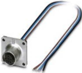
Sensor-/Aktor-Einbaubuchse, 4-polig, M12, A-kodiert, Vorderwand-/Vierkantflanschmontage, mit 0,5 m TPE-Litze, 4 x 0,34 mm 2
