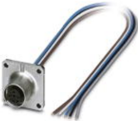
Sensor-/Aktor-Einbaubuchse, 5-polig, M12, A-kodiert, Vorderwand-/Vierkantflanschmontage, mit 0,5 m TPE-Litze, 5 x 0,34 mm 2
