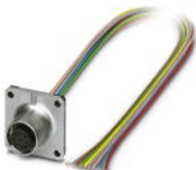
Sensor-/Aktor-Einbaubuchse, 8-polig, M12, A-kodiert, Vorderwand-/Vierkantflanschmontage, mit 0,5 m TPE-Litze, 8 x 0,25 mm 2
