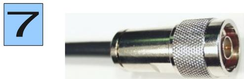
Das so vorbereitete Kabelende bis zum Anschlag in das Steckergehäuse einschieben. Mit zwei Maulschlüsseln 16 mm die Spannmutter handfest anziehen. Ein kleiner Spalt zwischen Mutter und Steckergehäuse sollte noch sichtbar sein!
