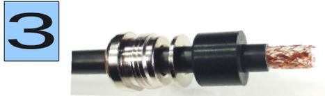
Mit einem Messer 8 mm des Außenmantels entfernen.
