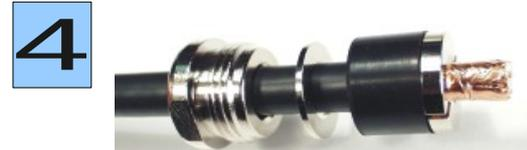
Kupfergeflecht im rechten Winkel hochbiegen. Kontakthülse zwischen Kupferfolie und Geflecht bis zum Anschlag einschieben. Überstehendes Geflecht abschneiden. Gummidichtung bis zur Kontakthülse nach vorne schieben.
