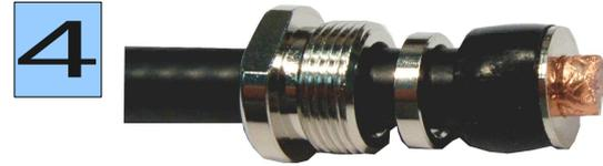
Kupfergeflecht im rechten Winkel hochbiegen. Kontakthülse zwischen Kupferfolie und Geflecht bis zum Anschlag einschieben. Überstehendes Geflecht abschneiden. Gummidichtung bis zur Kontakthülse nach vorne schieben.
