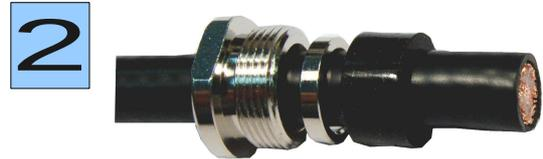
Schieben Sie Mutter, Druckring und Gummidichtung über das Kabelende.
