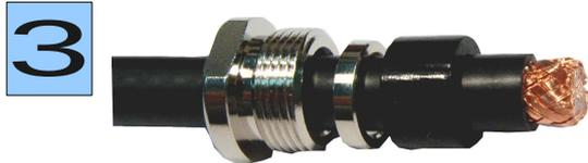
Mit einem Messer 4,5 mm des Außenmantels entfernen.
