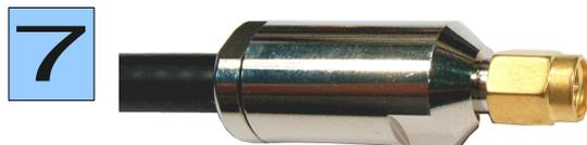
Das so vorbereitete Kabelende bis zum Anschlag in das Steckergehäuse einschieben. Mit zwei Maulschlüsseln 13 mm die Spannmutter handfest anziehen. Ein kleiner Spalt zwischen Mutter und Steckergehäuse sollte noch sichtbar sein!
