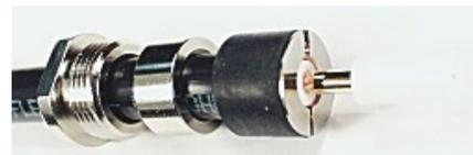
Innenstift auf den Innenleiter stecken und sorgfältig verlöten. Anschließend Teflon-Isolator aufstecken.
