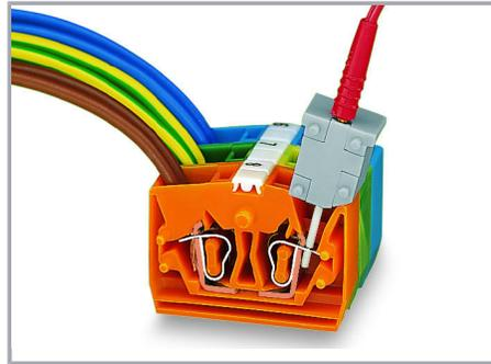
Tippkontaktierung, über die Feder des CAGE CLAMP®-Anschlusses, begrenzt den Nennstrom auf maximal 0,5 A und die maximale Prüfspannung auf 48 V; die Prüfstifte sind nicht berührungsgeschützt.
