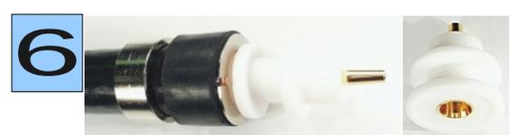
6 Innenstift in Telefon-Isolator schieben. Anschließend Innenstift vorsichtig auf den Innenleiter aufstecken. Tipp: Der Innenleiter kann vor dem Aufstecken des Innenstiftes mit einem hauchdünnen Vaseline-Film versehen werden. Das verbessert die Intermodulationsdämpfung und beugt Korrosion vor.
