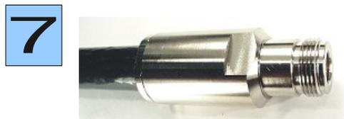
7 Das so vorbereitete Kabelende bis zum Anschlag in das Steckergehäuse einschieben. Mit zwei Maulschlüsseln 19 mm die Spannmutter handfest anziehen. Ein kleiner Spalt zwischen Mutter und Steckergehäuse sollte noch sichtbar sein!
