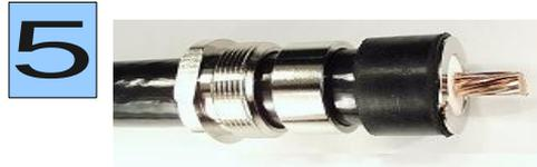
5 Mit einem Messer die Kupferfolie und das Dielektrikum entfernen. Der Innenleiter muss absolut rund bleiben, die scharfen Kanten entgraten.
