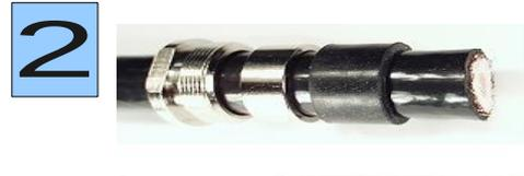
2 Schieben Sie Mutter, Druckring und Gummidichtung über das Kabelende. Tipp: Mit etwas Vaseline rutscht die Gummidichtung leichter über den Außenmantel.
