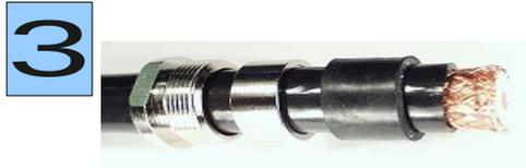
3 Mit einem Messer 7 mm des Außenmantels entfernen.
