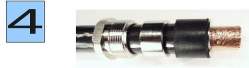
4 Kupfergeflecht im rechten Winkel hochbiegen. Kontakthülse zwischen Kupferfolie und Geflecht bis zum Anschlag einschieben. Überstehendes Geflecht abschneiden. Gummidichtung bis zur Kontakthülse nach vorne schieben.
