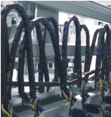
igus® E2 micro E-Ketten® sind stabil auch für die stehende Anwendung
