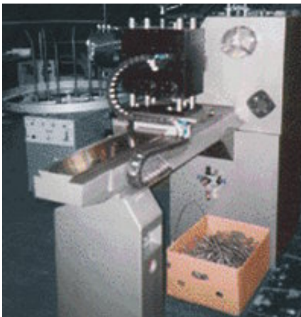
E2 mini E-Kette® in einer Werkzeugmaschine, kühlmitelbeständig
