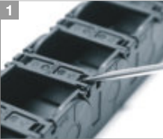
1 Stege aufhebeln und aufschwenken
