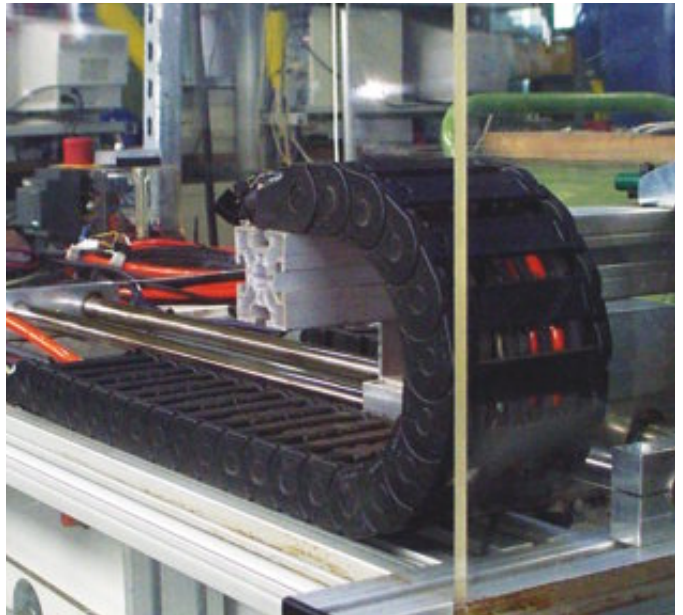
Serie 255 - kleine Teilung, ruhiger Lauf - Testaufbau im igus® Labor
