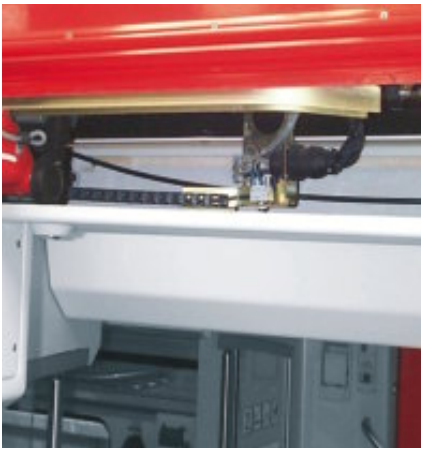
Schiebetür in einem Zug - UL 94 - V2 Version
