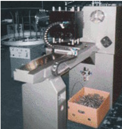
E2 mini E-Kette® in einer Werkzeugmaschine, kühlmitelbeständig
