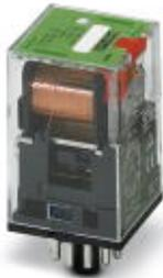
Steckbare Oktalrelais mit Leistungskontakten, 3 Wechsler, Prüftaste, mechanische Schaltstellungsanzeige, Spulenspannung: 230 V AC
