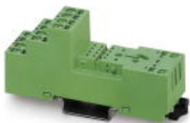
Relaissockel PR2-B, für Industrirelais REL-IR mit 2- oder 4-Wechslern, 1/3-stöckige Ausführung, Zugfederanschlüsse, Steckmöglichkeit für Eingangs-/Entstörmodule, zur Montage auf NS 35/7,5
