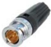
Der 75  $\Omega$  RearTwist<sup>®</sup> Large BNC Kabelstecker NBLC75BSX14 wurde für das Draka Kabel 1.4/6.6 AF entwickelt. Dieser Kabeltyp mit seinen niedrigen Dämpfungswerten wird für Übertragungen über weite Distanzen und sehr oft in Kombination mit HDTV Signalen verwendet.
