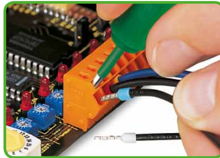
Leiter anschließen/lösen - Leiter mit Aderendhülse.
