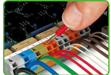
Prüfen mit Prüfstecker Ø 2 mm.
