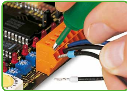
Leiter anschließen/lösen - Leiter mit Aderendhülse.
