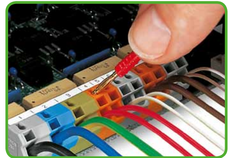
Prüfen mit Prüfstecker Ø 2 mm.
