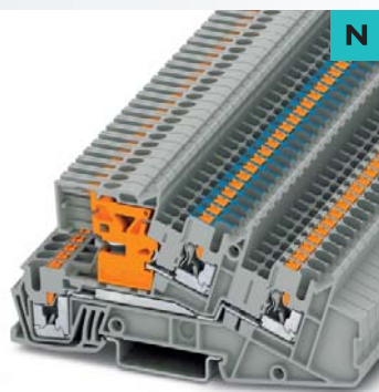
4 (4) mm 2 , 30 A, Dreistockklemme, 1 x Außenleiter L, 1 x N-Leiter trennbar
