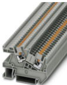
Installationsklemme, Push-in-Anschluss, Querschnitt: 0,14 mm 2 - 4 mm 2 , AWG: 26 - 12, Breite: 5,2 mm, Farbe: grau, Montageart: NS 35/7,5, NS 35/15
