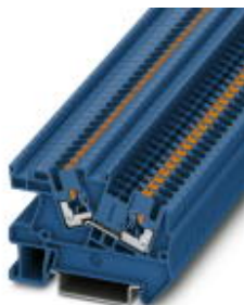
Installationsklemme, Push-in-Anschluss, Querschnitt: 0,14 mm 2 - 4 mm 2 , AWG: 26 - 12, Breite: 5,2 mm, Farbe: blau, Montageart: NS 35/7,5, NS 35/15
