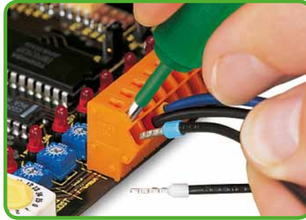
Leiter anschließen/lösen - Leiter mit Aderendhülse.
