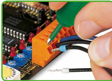
Leiter anschließen/lösen - Leiter mit Aderendhülse.
