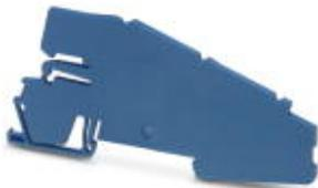
Auflagebock, Halterung für Sammelschienen, alle 20 cm zu setzen, Länge: 103 mm, Breite: 2 mm, Höhe: 46 mm, Farbe: blau
