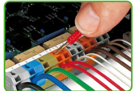
Prüfen mit Prüfstecker Ø 2 mm.
