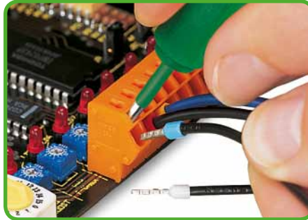
Leiter anschließen/lösen - Leiter mit Aderendhülse.
